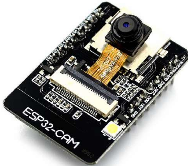
Fig 3.10 ESP 32 Camera Module [12]
