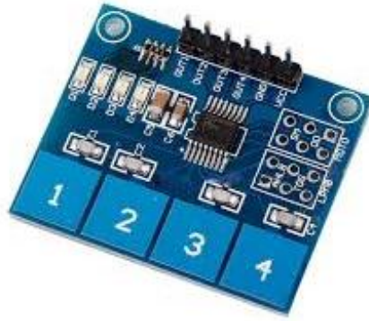
Fig. 3.10: TTP224 Capacitive Touch Sensor. [16]
