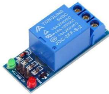
Fig:4.3 Relay module [6]
