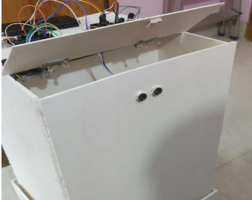
Fig. 5.3.1: Automatic Dustbin lid open and close lid system
